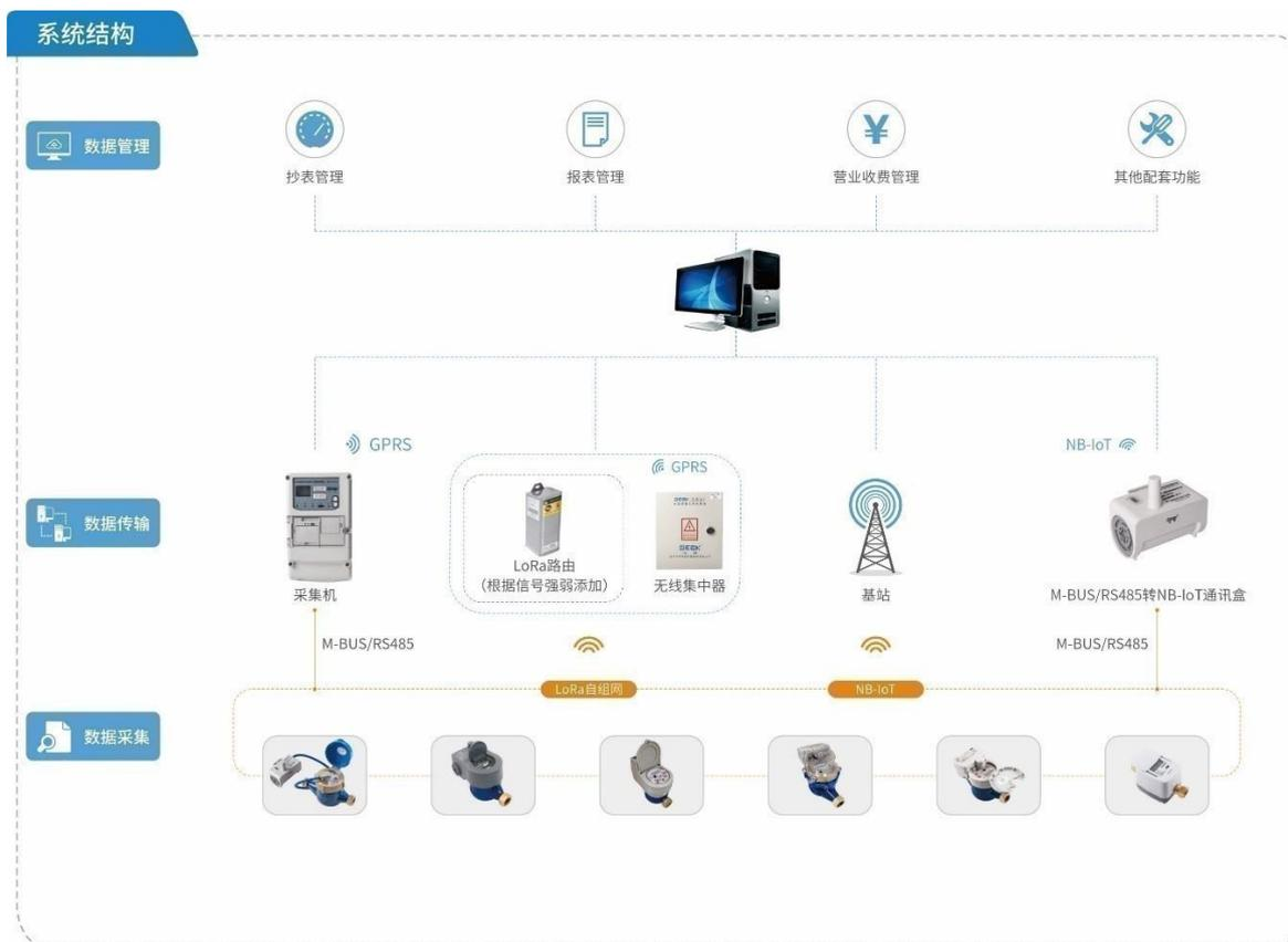
智能水表由计量传感器、智能基表及相关零配件构成，根据计量传感器原理不同，公司生产销售的智能水表最主要有以下几类：磁敏式脉冲智能水表及计量传感器、电感式脉冲智能水表及计量传感器、摄像直读智能水表及计量传感器、厚膜直读智能水表和光电直读智能水表、超声波智能水表等。智能水表是智慧水务重要物联网终端设备之一，可获取精确的用水数据，并解析不同用户群体的典型用水模式，实现对异常用水模式的甄别。
